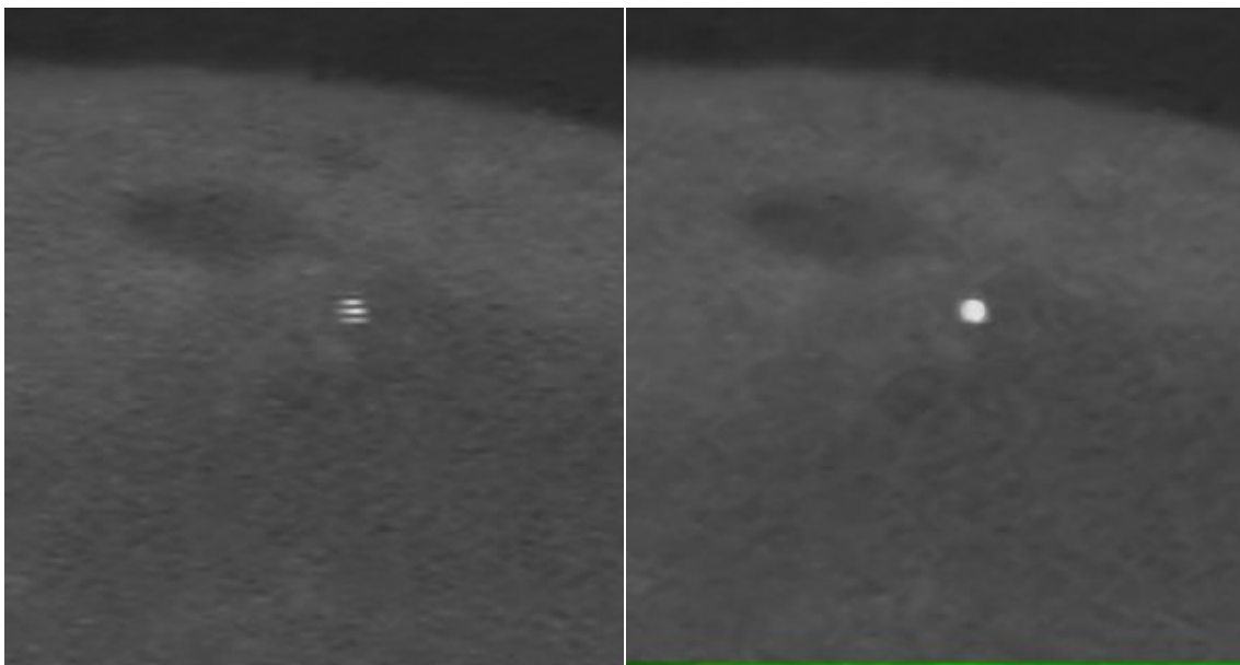
Figura 4.2. Izquierda: imagen de un destello de impacto que muestra el efecto peine que surge como consecuencia del proceso de entrelazamiento de vídeo. Derecha: imagen desentrelazada, en la que se ha eliminado este efecto.
