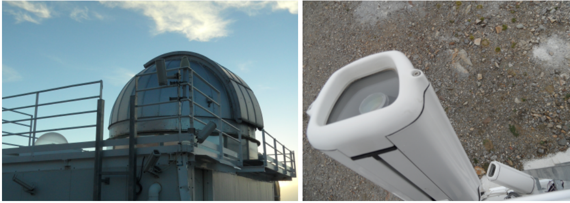
Figura 3.12. Imágenes de la estación de detección de meteoros del Observatorio de Sierra Nevada. Las cámaras se ubican en carcasas estancas calefactadas.
