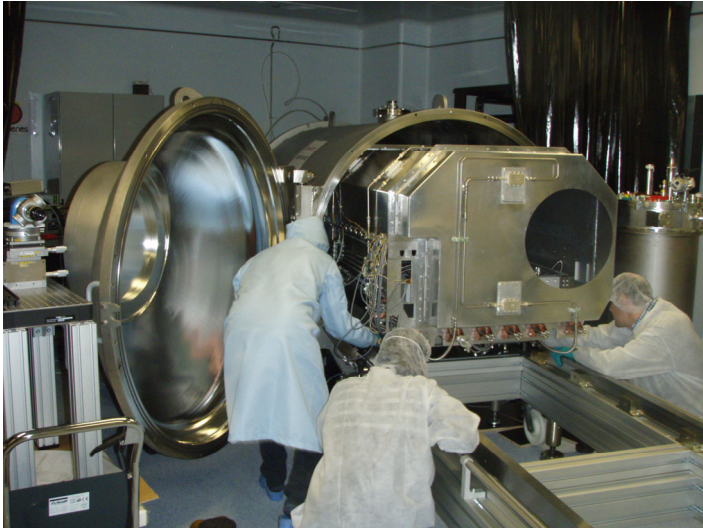
Fig 3.- Montaje del brazo en Infrarrojo cercano de CARMENES en el Observatorio de Calar Alto. Los detectores del espectrógrafo deben instalarse en el interior de una cámara criogénica de vacío con unas condiciones de presión y temperatura muy estables. Crédito: Pedro Amado/Marco Azzaro - IAA/CSIC. Distribution license: Creative Commons Attribution 4.0 International (CC BY 4.0).
